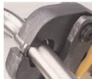
2.- Grada ut- och insidan av röret för att undvika skador på O-ringen.
